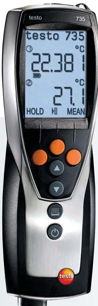
Si se usa la sonda insertable Pt100 de inmersión/penetración de elevada precisión, el sistema alcanza una exactitud de 0.05 °C con una resolución de 0.001 °C. Por tal motivo, el sistema de medición resulta ideal como patrón de referencia. El instrumento también incluye perfiles de usuario configurables, es decir, teclas programables para que activen ciertas opciones de menús relativas a cada aplicación, que facilitan el manejo rápido e intuitivo.
